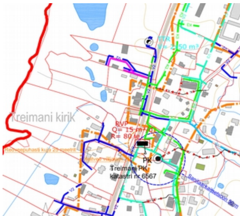
Skeem 1 - Treimani küla ühisveevärgi ja kanalisatsiooni üldskeem, OÜ Alkranel, töö nr 01-03-2018-ÜVK.
